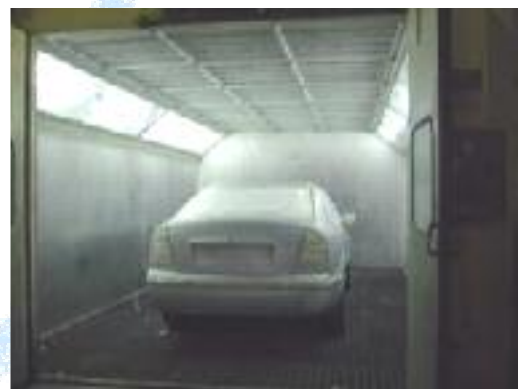
Cabina al Horno de Alto Rendimiento
